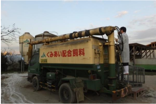
写真3 エコフィードを他の配合飼料と混合するバルク車
