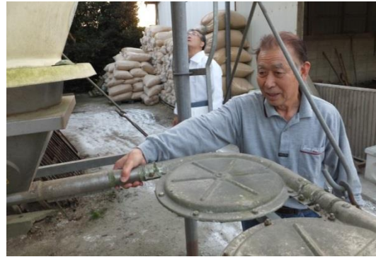
写真4 目詰まりを防ぐため、太くした飼料配送用のパイプ
